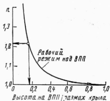
Рис. 7. Влияние близости земли на подъемную силу крыла малого удлинения ( n=c_y с учетом эффекта близости земли/ c_y без учета эффекта близости земли)
