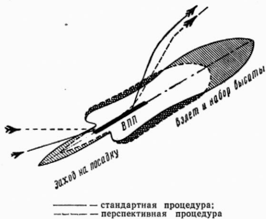
Рис. 19. Влияние эксплуатационных процедур СПС на площадь зоны с повышенным уровнем шума в районе аэропорта
