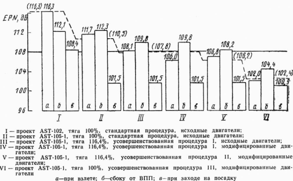
Рис. 18. Уровни шума для различных условий и процедур взлета, полученные при помощи моделирования (в скобках уровни шума по нормам FAA)
